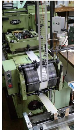
「インク（写真3）は粘り気があるので、印刷機を回すスピードによってはうまくインクが乗らなかったり、インクがかすれたりします。シールの大きさや、印刷部の面積によって送り速度を変えるなどの条件を調整しています。特に高さが数mmしかないような小さなシールは他社では印刷が難しく、当社の得意分野となっています。（写真4）」
